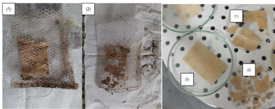
Figura 2- Aspecto visual dos filmes após 60 dias do ensaio de biodegradação no solo: (1) AC 5% OE (2) AC 10% OE (3) Ac Puro.
