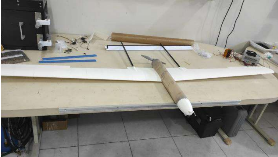
Imagem 2: Motor elétrico e hélice do RPA.
