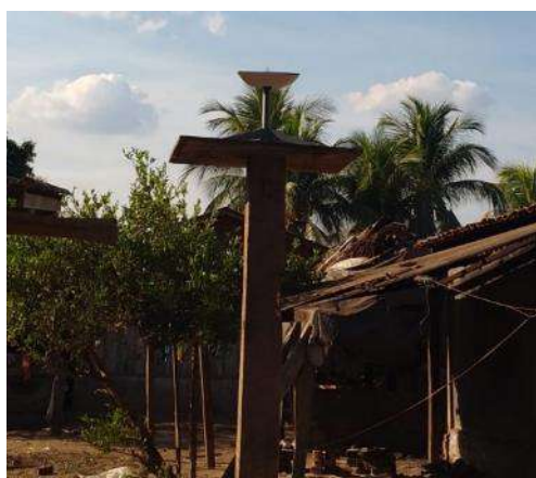
Imagem 3: Antena de internet via satélite (Starlink) localizada na aldeia Kôkraxmôr, rio Xingu. Fonte: Bepnhô Kayapó.
