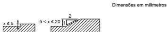
Figura 13 - Tratamento de desníveis
