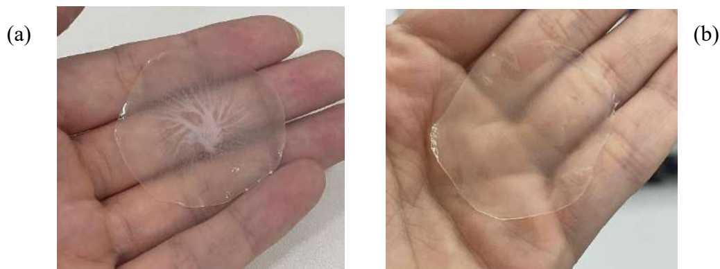
Figura 2 – Imagens dos filmes PVA:PVP (3:2) – 20mL – incorporados com 25mg de DAP (a) e PVA:PVP (3:2) – 20mL – incorporados com 10mg de DAP (b).
